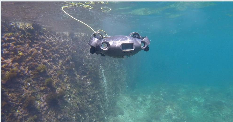
FIFISH V6 Expert di QYSEA è un ROV subacqueo professionale per **l'esplorazione subacquea**. Dotato di una coppia di luci LED ultra luminose da 6000 lumen insieme alla sua fotocamera 4K UHD offre immagini nitide anche negli spazi più bui. Consente **l'integrazione** efficiente di un'ampia gamma di strumenti per affrontare diversi scenari e attività. Dotato di 6 propulsori ha una durata di
