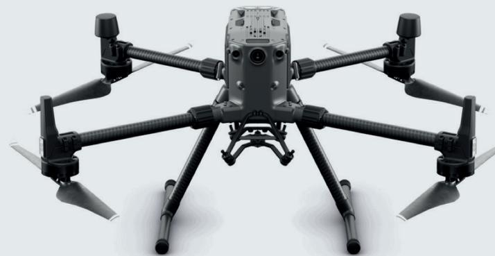
Il sistema drone su base DJI Matrice 300 RTK ci permette di effettuare rilievi rapidi su aree estese per individuare zone hotspot, al fine di identificare con precisione eventuali **perdite di gas o liquidi e/o materiali inquinanti e monitorarne le emissioni**. I dati rilevati con piani di volo automatizzati e programmati ci consentono di monitorare un sito nel tempo e verificarne i cambiamenti e ottenere mappature specifiche per aree geografiche. I cambiamenti significativi
